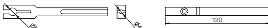
Messuhrhalter Aufnahme Ø 4mm und 8mm Dial gauge holder mounting hole Ø 4mm and 8mm
